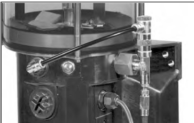
Fig. 5-2 Valvola limitatrice della pressione con ritorno del grasso
