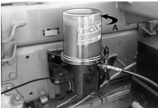
Fig. 9-1 Riempimento del serbatoio della pompa B-P203-030a09
