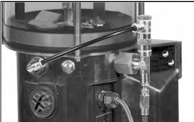
Abb. 5-2 Druckbegrenzungsventil mit Fettrückführung
