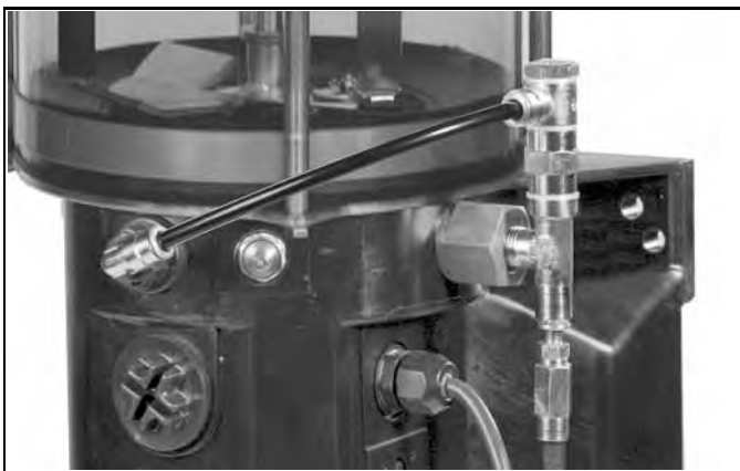
Fig. 5-2 Soupape de limitation de pression avec retour de la graisse
